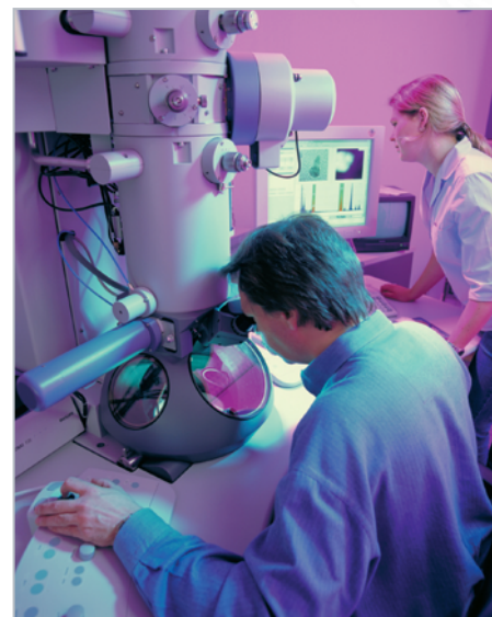
Ein hochauflösendes Elektronenmikroskop im Campus Duisburg
